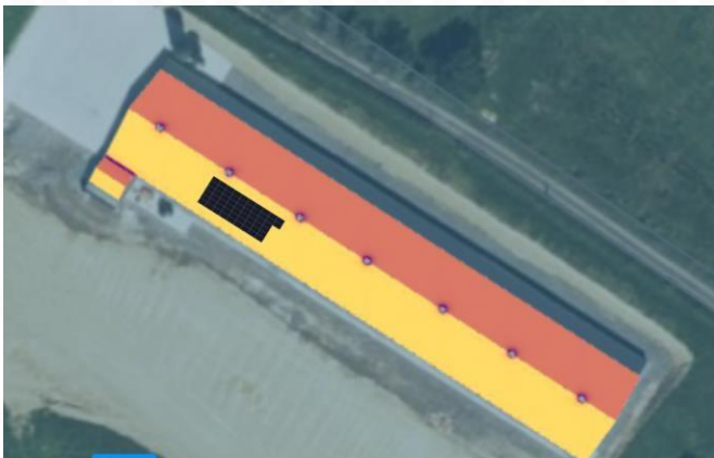
Figura 1: Proposta de sistema fotovoltaic solar a una unitat de pollastres d'engreix.
