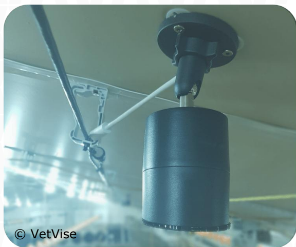
Figura 1. Les càmeres són de gran angular a prova d'aigua, amb classificació IP67. L'alimentació elèctrica és a través de switches PoE (Power over Ethernet) en l'exterior de la nau.
