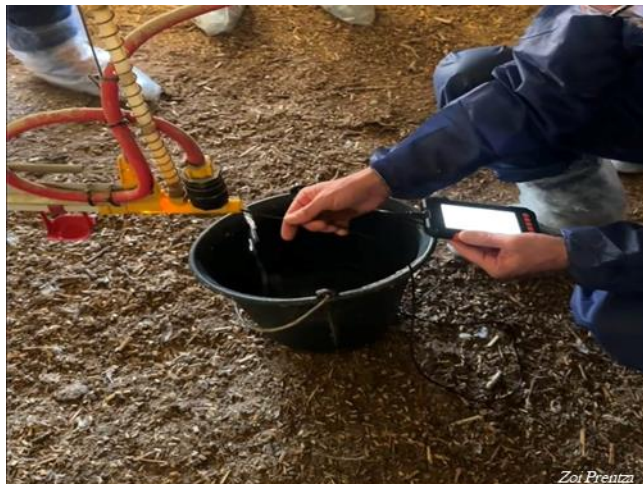
Monitoratge de l'acumulació de biopel·lícula en el sistema d'aigua mitjançant un endoscopi.
