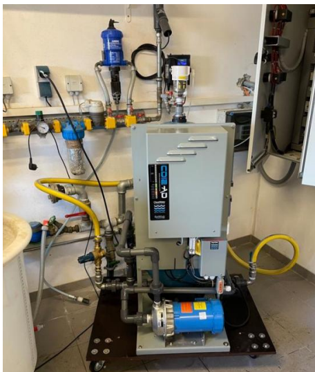
Fig. 2: El concentrador d'ozó i la bomba es connecten fàcilment al circuit. (© O 3 Tech GmbH).
