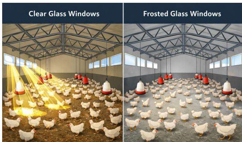
Figura 2: Representació il·lustrada de finestres bilaterals en un galliner; vidre clar versus vidre esmerilat i els efectes de la llum al sòl.
