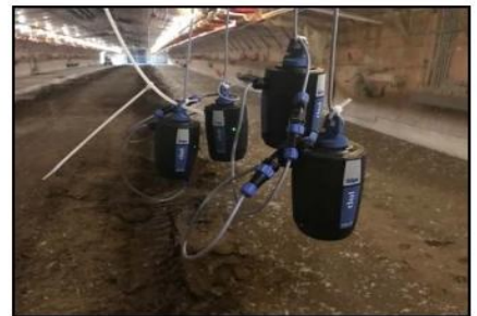
Figura 2. El amoníaco sondea en varios puntos cerca de la basura, a nivel de ave.
