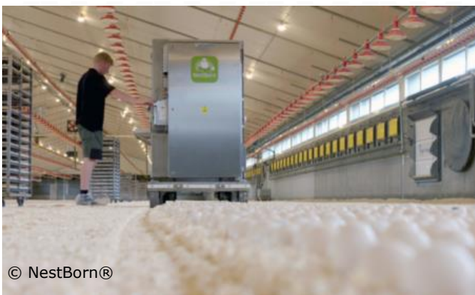
Figura 1. La màquina de col·locació d'ous NestBorn® col·loca els ous no eclosionats directament sobre el jaç en la granja. La seva capacitat és de 60.000 ous incubables per hora.
