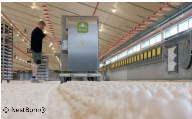
Figura 1. La máquina de colocación de huevos NestBorn® coloca los huevos no eclosionados directamente sobre la cama en la granja. Su capacidad es de 60.000 huevos incubables por hora.
